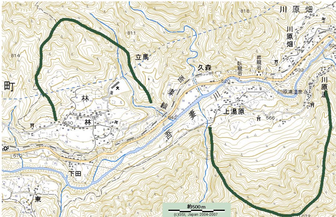
図一 八ッ場ダム湛水域の古期大規模地すべり（2万5千分の1地形図長野原図幅の一部に書き込み）。（甲D第14号証9頁より）
