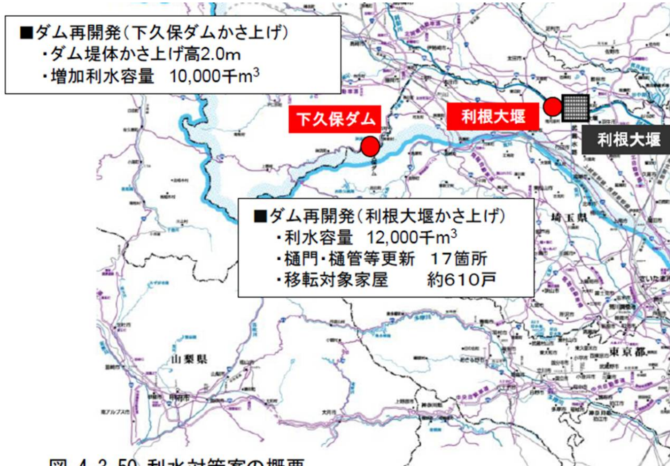
図 4-3-50 利水対策案の概要 ケース4-1（利根大堰かさ上げ＋下久保ダムかさ上げ＋ダム体
