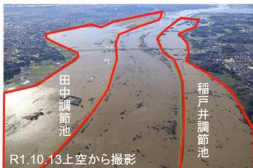
を遊ばすように逃がしていた。現在は遊水地部分を掘り下げ、河道に沿って越流堤を設け洪水を一時的に貯留する調節池になっている。田中調節池は越流堤を越えた洪水は河川区域内の農地に広がる。どちらも下流部の洪水流量のピークを柔らかく下げる役割に違いはない。
