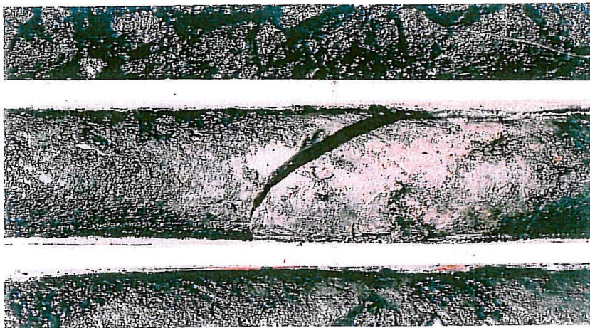
スリッケンサイドを伴う粘土化ゾーン (YB-63:26.30～26.50mの試験用供試体)
